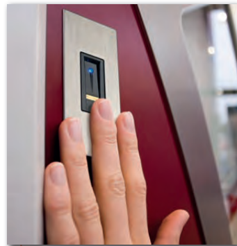
INTEGRA FINGERSCAN AF "ADMINFINGER" Scanner am Türblatt montiert Steuereinheit micro - verdeckt
